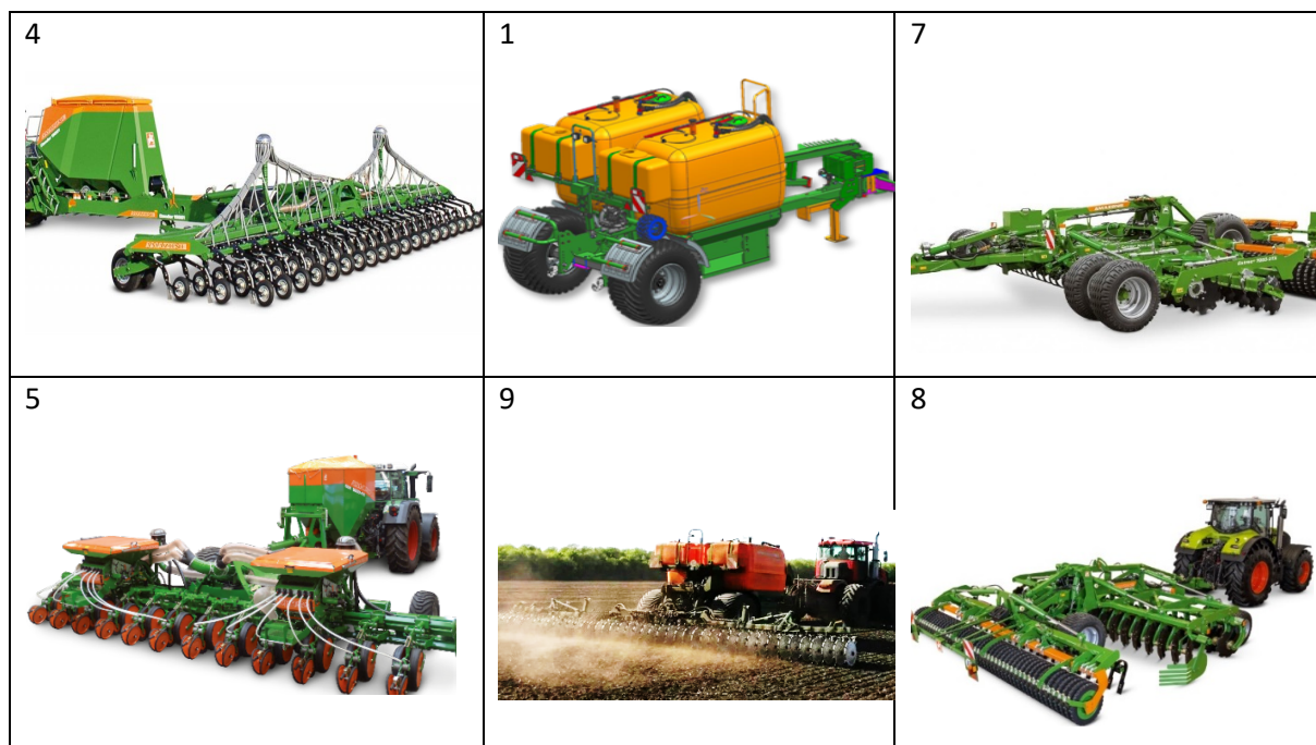
Рисунок 4. Инновационный многофункциональный технологический комплекс FDC-6000 (1,2) с фирменными сеялками (3,4,5), почвообрабатывающими машинами (6,7,8) и ликвилайзером (9)
