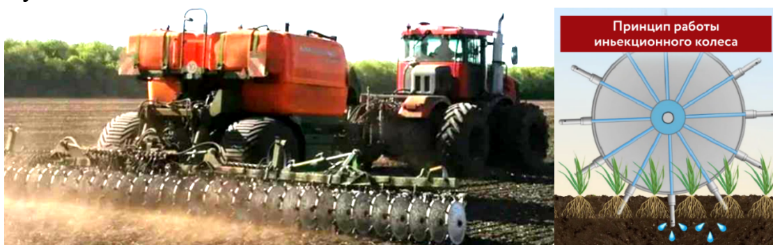
Рисунок 5. Инновационный агрегат АО «Евротехника» - Ликвилайзер
